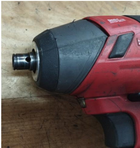
Obr.1 Poškodené upínanie nástroja
