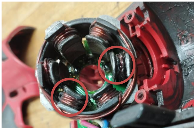
Obr.2 Poškodenie vinutia statora
