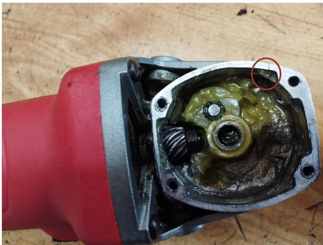
Obr.2 Prasklina puzdra prevodovky po odstránení krytu
