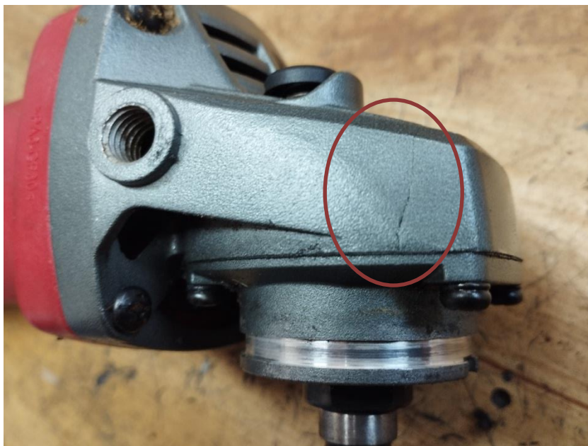
Obr.1 Prasklina na puzdre prevodovky
