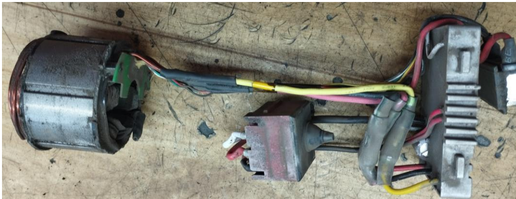
Obr.2 Zanesenie elektroniky, spínača a statora nečistotami
